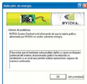
Antes de nada, instala los controladores ForceWare 78.01 y después la aplicación nTune de nVidia, que monitoriza el funcionamiento de la tarjeta gráfica. Si tiene algún problema de hardware, debería aparecer un mensaje de aviso indicando cuál es el problema. Lo más probable es que se trate de una alimentación eléctrica insuficiente, revisa el cable de alimentación.
